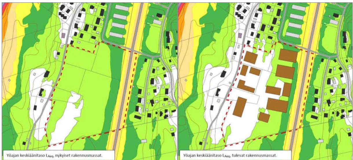
Kuva 6. Yöaikaiset keskiäänitasot L_{Aeq} nykyisillä ja tulevilla rakennusmassoilla.
